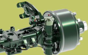
BPW AGRO Turn Präzise Lenkung mit Lenkwinkelsensor
